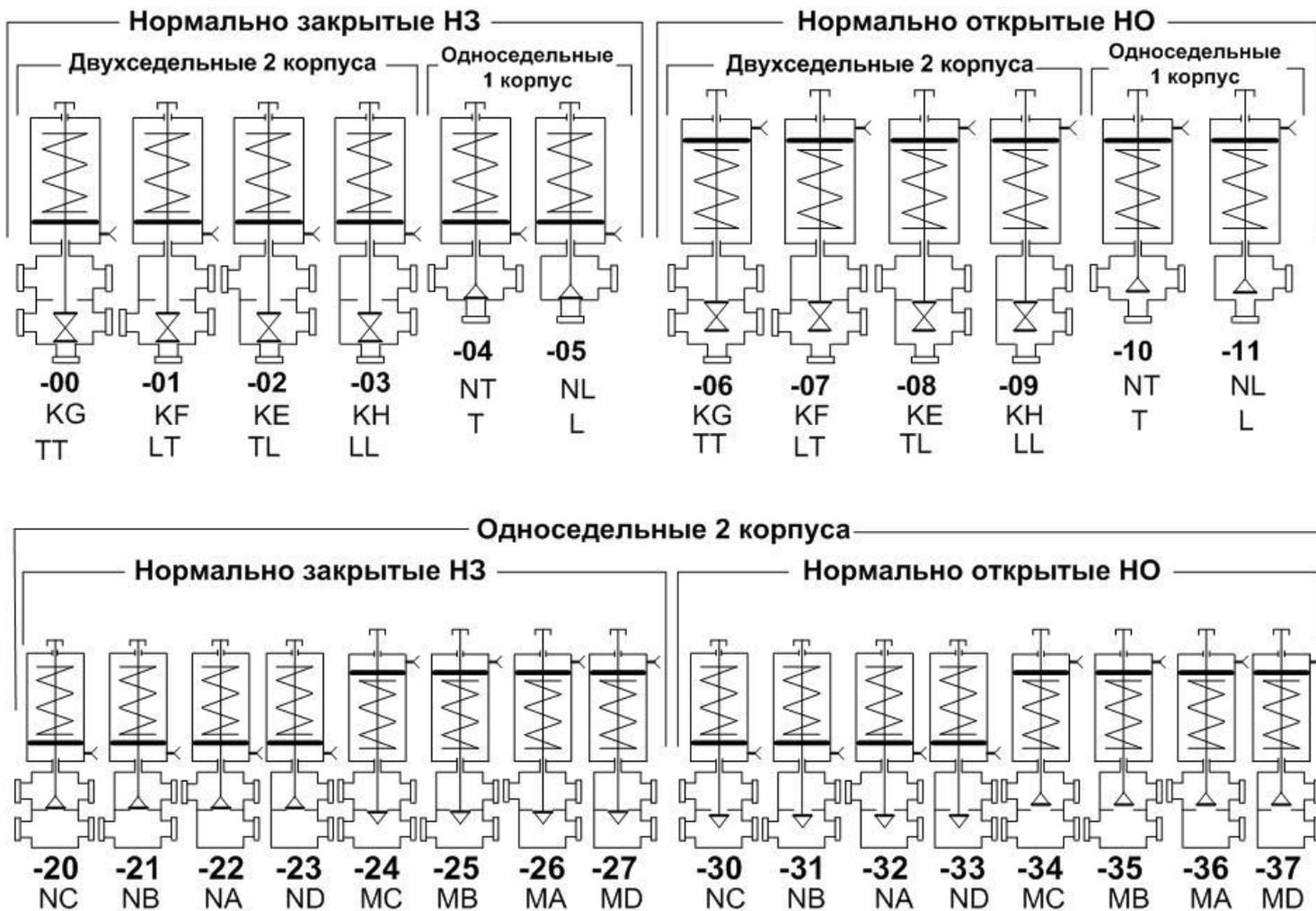
1. Под схематичными изображениями клапанов указаны номера исполнений и их аналоги.
